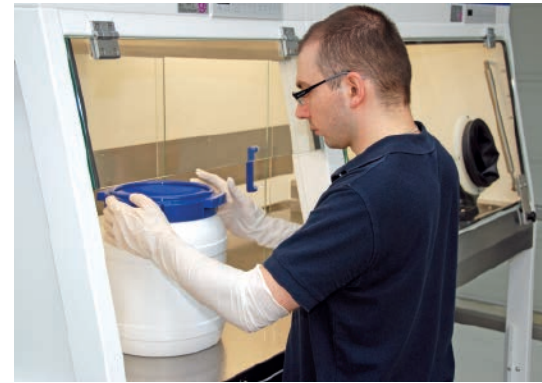
▲ Abb. 2: Beim Befüllen der Extrusionsanlage verhindert ein Überdruck an der Materialschleuse, dass das Kunststoffgranulat mit Partikeln aus der Umgebungsluft in Kontakt kommt.
