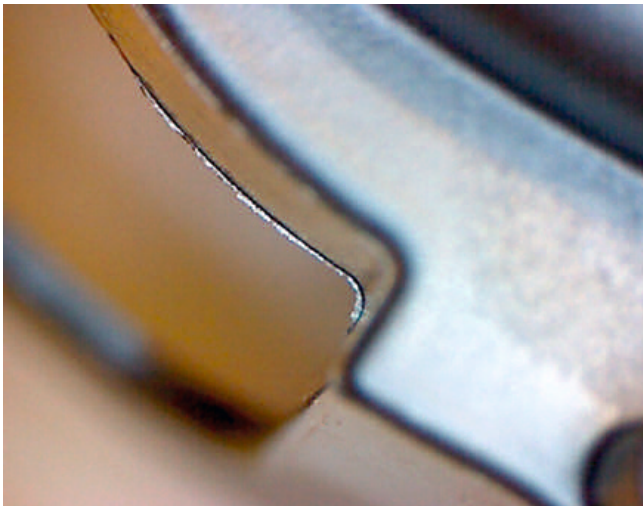
Bild 6. Die Grathöhe der Spritzteile hängt direkt vom Fließverhalten der Schmelze und somit von ihrer Viskosität ab. Mit dem Fillcontrol-System wird u. a. die Viskosität der Schmelze in Form von Schergeschwindigkeit und Schubspannung bestimmt und geregelt, woraus sich auch die Grathöhe der Teile ergibt. Im Bild rechts ist ein deutlich höherer Grat aufgrund einer niedrigeren Schmelzeviskosität zu erkennen
