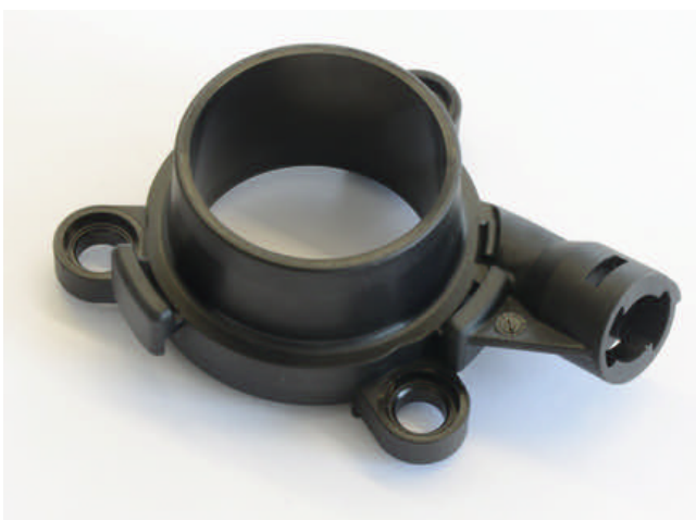
Bild 3. Die Produktion dieses Zylindergehäuses aus einem PPA-GF50 stellt hohe Anforderungen an die Berstdruckfestigkeit, Oberflächenrauigkeit, Maßhaltigkeit und Gratfreiheit
