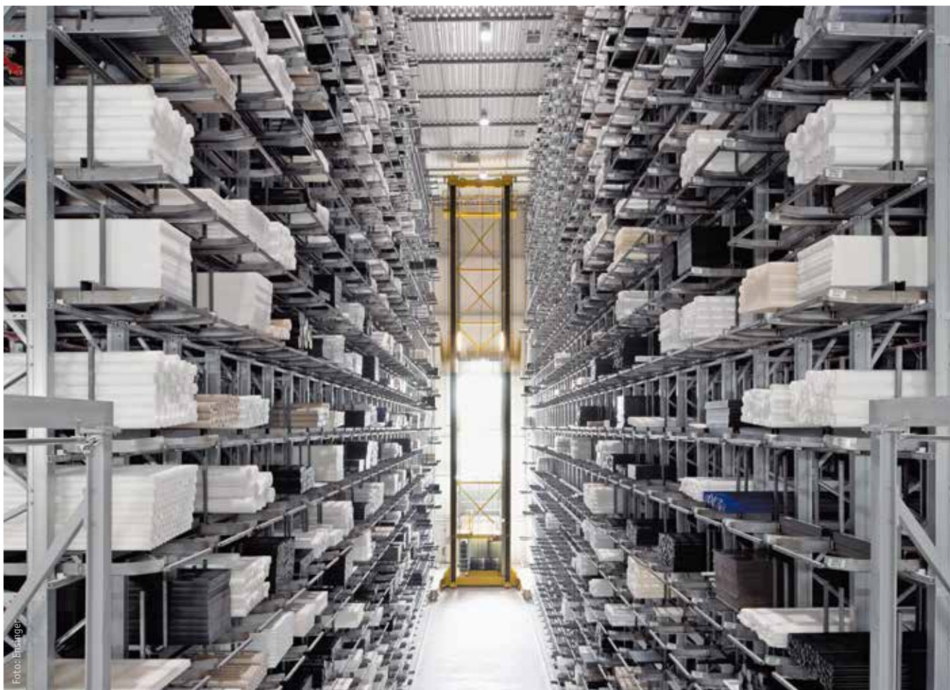
Dank des neuen, 24 m hohen Langgut-Hochregallagers kann Ensinger sein Portfolio ständig verfügbarer Halbzeuge um neue Produkte erweitern.
