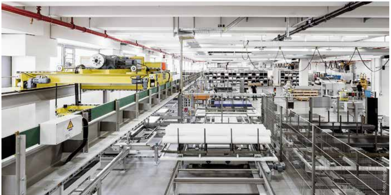
Die bis zu 3 m langen Platten und Stäbe lagern auf sogenannten Skids, die mit bis zu 2,5 t belastet werden können und Basis für vollautomatischen Transport und die automatisierte Lagerung sind.
