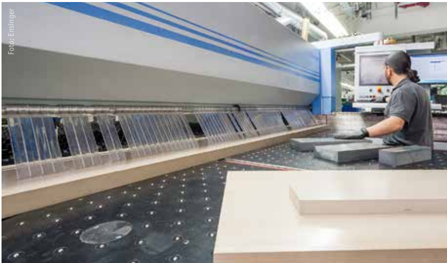
David Calero, Schichtführer, an der größten Plattensäge bei Ensinger, einer HPP 570 P von Holzma, die Platten und Plattenstapel bis ca. 160 mm Dicke zerteilen kann.
