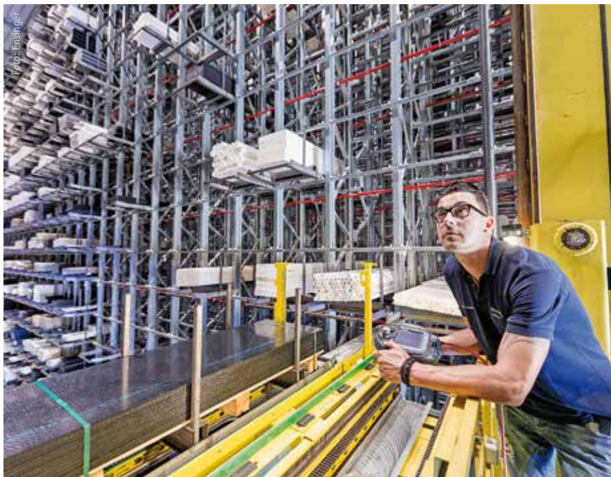
Logistik-Meister Florian Maiwaldt am computergestützten Logistikleitstand zur Steuerung der Fördertechnik im Hochregallager.
