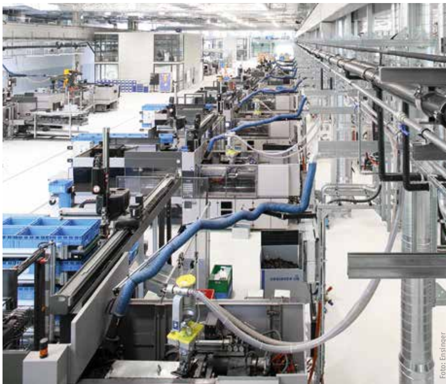
Im Werk Rottenburg-Ergenzingen arbeitet Ensinger mit rund 50 Spritzgießmaschinen der Marken Arburg und Engel im Schließkraftbereich von 500 bis 5.000 kN.
