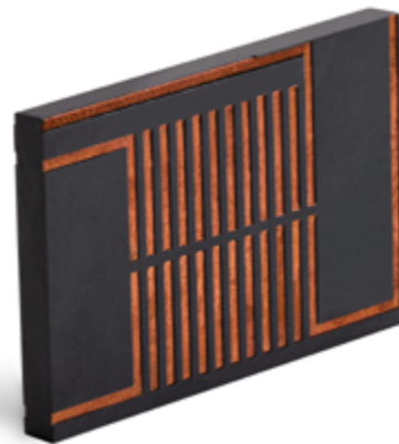
Bei Transformatoren limitiert die herkömmliche Wickeltechnik weitere Miniaturisierungsmöglichkeiten. LDS-MID-Transformatoren werden ohne Gehäuse montiert. Dadurch kann bis zu 80% an Volumen und Gewicht eingespart werden.
