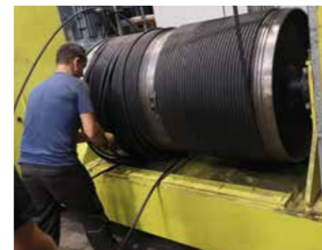
Demontage der Seiltrommel am Regalbediengerät.
