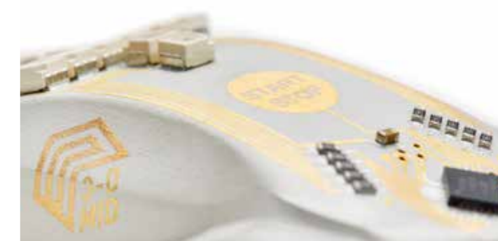
MIDster: Muster eines spritzgegossenen Schaltungsträgers.
