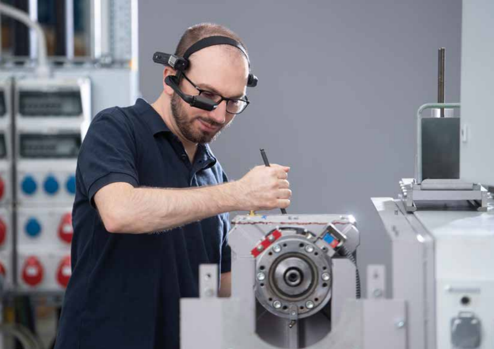
Esref Halil demonstriert die Datenbrille im Technikum des Service-Centers Extrusion Engineering. Durch die Video-Kommunikation von Experte zu Anwender können Servicetätigkeiten visuell unterstützt und schrittweise angeleitet werden.
