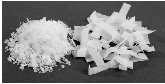
Hohe Zähigkeit verhindert Ab- und Ausbruch beim Zerspanspannen. Spanvergleich zwischen TECADUR PET (links) und TECAPET (rechts).
