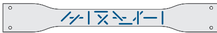
Probekörper aus extrudiertem und zerspantem Halbzeug Ungeordnete Ausrichtung der Fasern und Makromoleküle
